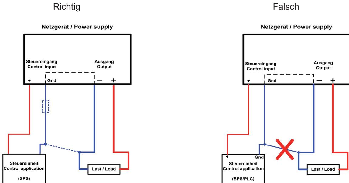
Um die Spannung an der Last zu messen, wird „Remote sense“ verdrahtet und aktiviert. Der Meßausgang UMON, für den Istwert der Spannung, repräsentiert dann den Spannungswert an der Last und kann mit der Steuerapplikation erfaßt und gemessen werden. Dies verhindert, daß Laststrom über eine der Steuer- bzw. Lastleitungen fließt.
