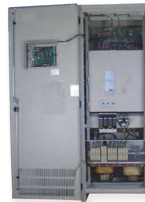
Bidirektionalität: Laden von EV und PHEV mit bis zu 600V und 30kVA
